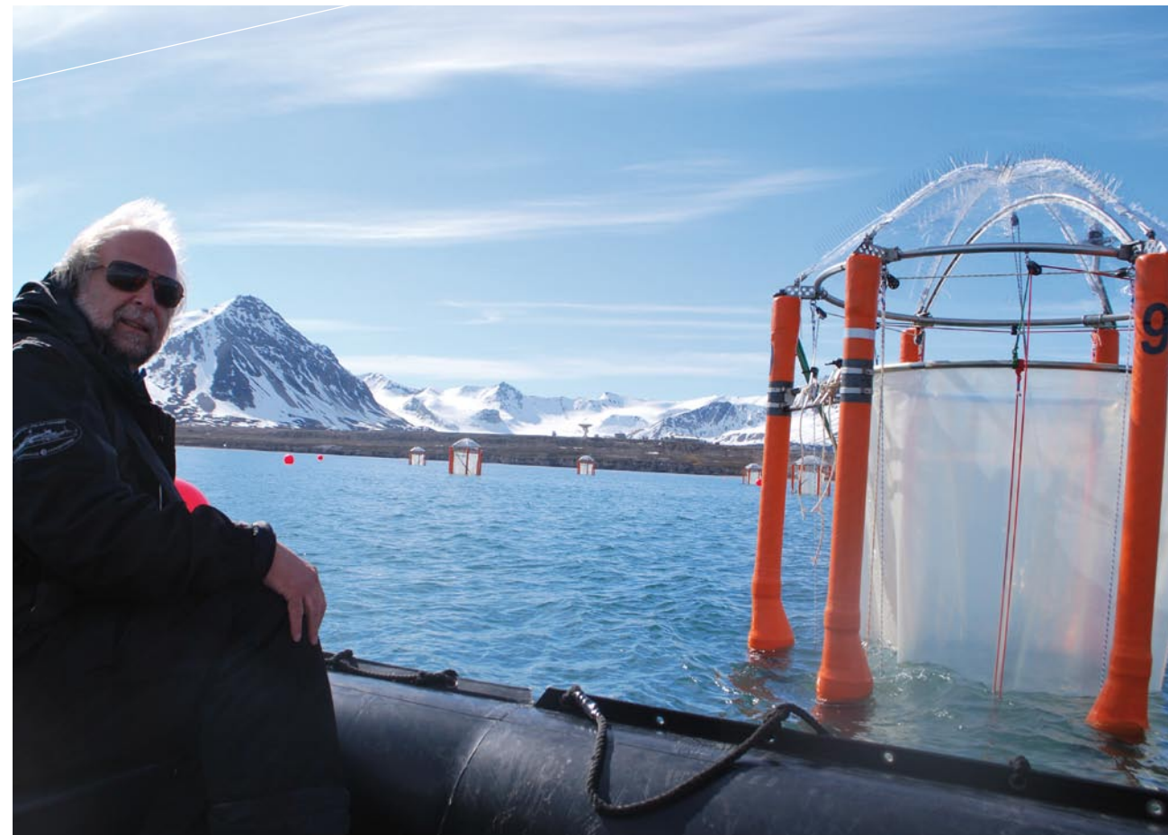
Han de Kluijver in de baai van Ny Alesund (Spitsbergen, 27 juni 2010) bij een aantal Mesocosms, enorme 'zeezakken' (17 meter lang) waarin het effect van CO2 op het in de zakken verzamelde zeewater wordt bestudeerd.
